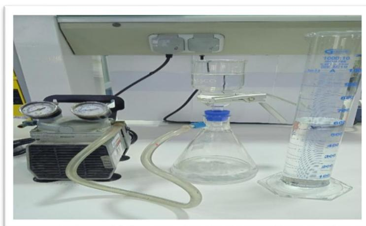
Figure 14 : Le système de filtration
