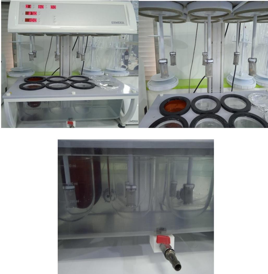
**Figure 20** : Le milieu de dissolution, panier et les gélules dans les godets
